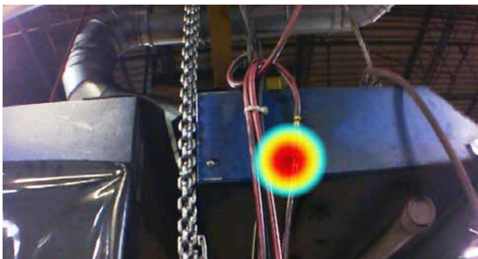
ii900 超音波カメラで撮影した産業環境でのエアリーク画像。
