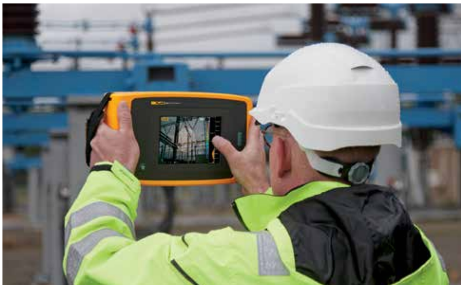
高電圧印加時の部分放電を検出する ii910 超音波カメラの画像。
